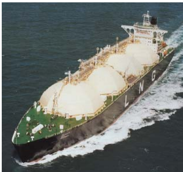
Sphere Containment LNG Vessel
